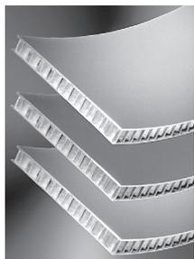
ALUCORE® ist eine Aluminium-Sandwichplatte mit hoher Biegefestigkeit bei niedrigem Gewicht. Im Gegensatz zu herkömmlichen Wabenkern-Verbundplatten werden die Systemkomponenten „Aluminiumwabenkern“ und „Aluminium-Deckbleche“ in einem kontinuierlichen Fertigungsverfahren zähelastisch verklebt.
