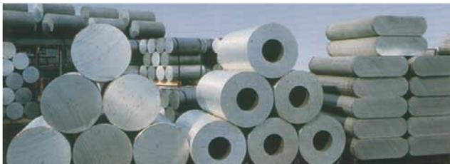
Die Pressgeschwindigkeit hängt dabei von der Legierung und der Komplexität des Profils ab und beträgt gewöhnlich 5 – 80 m/min. Der so erzeugte Profilstrang **9** ist je nach Profildgewicht und eingesetztem Pressbolzen
