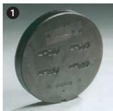
Bei Vollprofilen besteht das Werkzeug aus einer flachen Scheibe mit einer draht-erodierten Öffnung, welche die gesamte Kontur des Profils formt.
