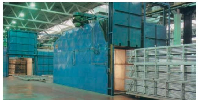
Diese Warmaushärtung dauert ca. 4 – 8 Stunden und erfolgt bei einer Temperatur von ca. 190°C. Danach sind die Profile bereit zur Weiterverarbeitung oder Auslieferung.
