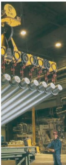
Strangguss in Längen von ca. 8 m hergestellt und entsprechend den jeweiligen Anforderungen, in unterschiedlichen Abmessungen und Legierungen durch die werksinterne Gießerei, oder namhafte Zulieferbetriebe geliefert. Das gebräuchlichste Einsatzformat der Pressbolzen liegt zwischen 120 – 550 mm Durchmesser und Längen von 300 – 1.000 mm. Der Zuschnitt **2** erfolgt für den Profilquerschnitt individuell.
