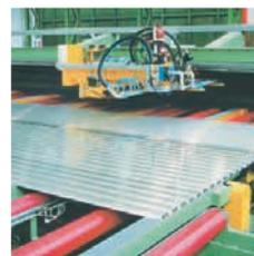
Anschließend werden die Profile in geeignete Längen getrennt und je nach der verwendeten Legierung noch zum Warmaushärten befördert, um die gewünschte Endfestigkeit zu erhalten.
